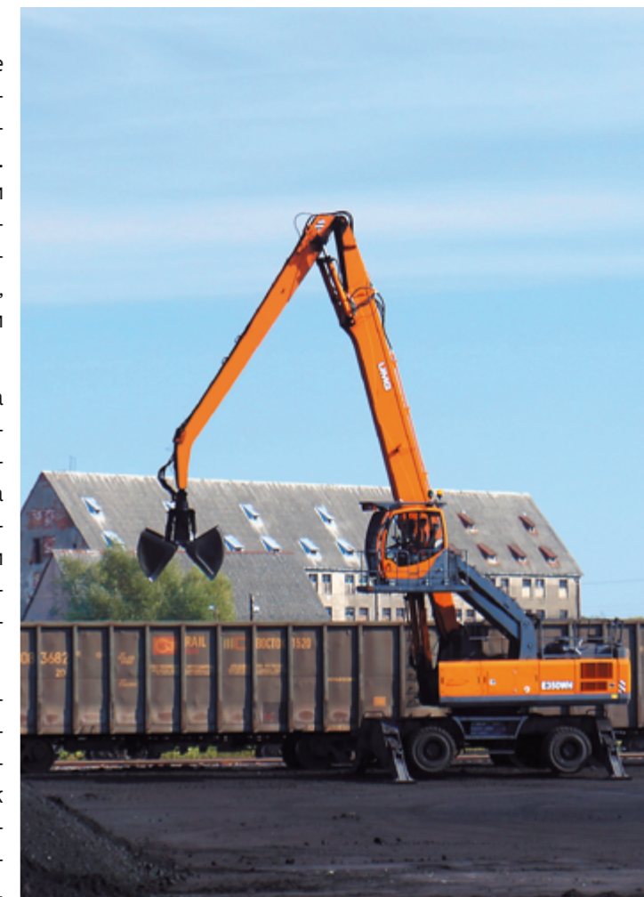
Параметрическая схема E350WH Стрела 9900 мм Рукоять основная 6900 мм
